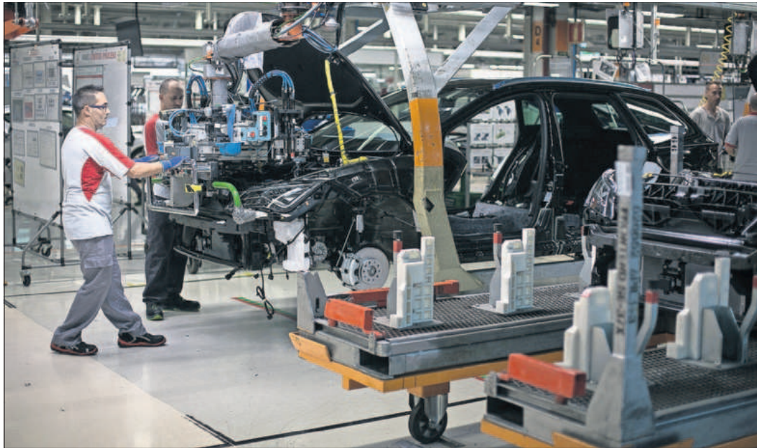
Cadena de montaje de los frontales del Seat León en la fábrica de Martorell. / ALBERT GARCÍA
